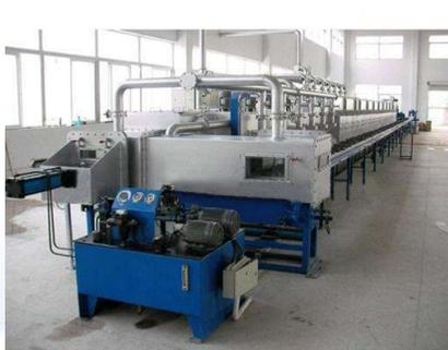
新型锂电池材料烧结炉
